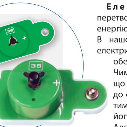
**Електродвигун** перетворює електричну енергію на механічну. В нашому випадку – електричну енергію на обертання валу. Чим вища напруга, що прикладається до електродвигуна, тим вища швидкість його обертання. Але занадто велика напруга може привести до пошкодження електродвигуна.
