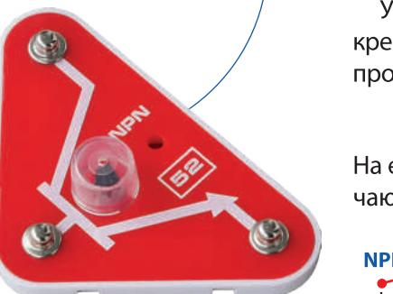
**Транзистор** – електронний напівпровідниковий пристрій, який в залежності від схеми включення призначений для посилення, перемикання, генерації або перетворювання електричних сигналів. Має три виводи – колектор **C**, база **B** та емітер **E**.
