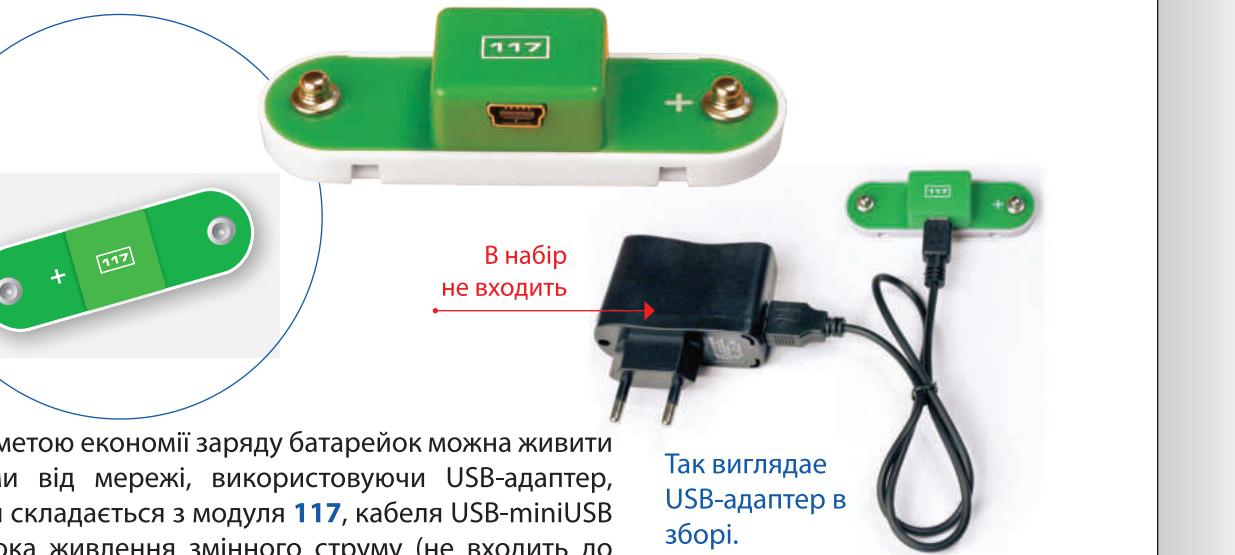
З метою економії заряду батарейок можна живити схеми від мережі, використовуючи USB-адаптер, який складається з модуля 117, кабеля USB-miniUSB і блока живлення змінного струму (не входить до набору). Ви можете використовувати практично будь-який блок живлення змінного струму, за допомогою якого заряджаєте свій смартфон або планшет (вхід: ~220В/50Гц, вихід: 5В/0,5-2А).
